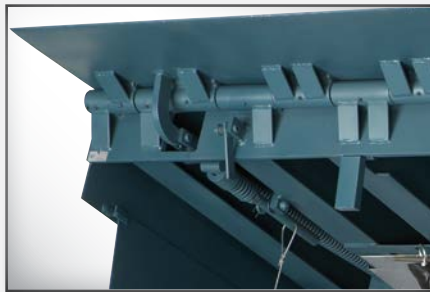
El reborde tiene una extensión confiable por medio de un exclusivo mecanismo de enganche de reborde y es completamente flexible si un remolque lo impacta en el retroceso.
