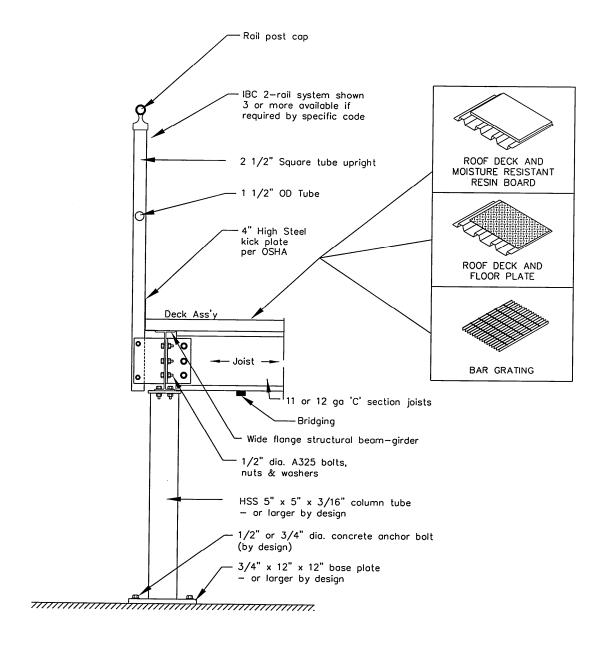
BEAM AND C-SECTION MEZZANINE SYSTEM
